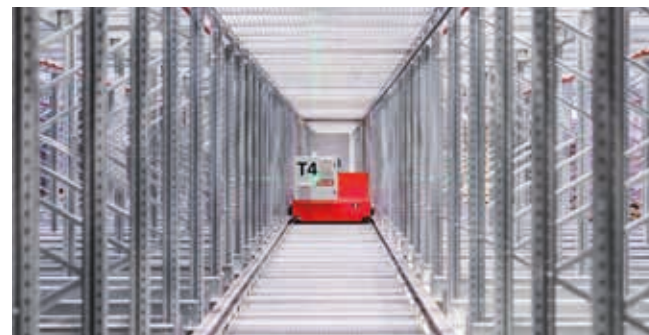
Das vollautomatische SMB-Kompaktlager: zeitgleiche Ein- und Auslagerung auf jeder Ebene
